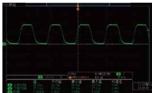
IT8906A-1200-240 5kHz动态加载0A-50A
