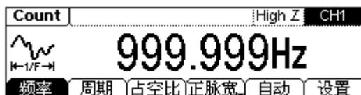
内置频率计测量范围 100 mHz ~ 200 MHz。可测量参数：频率、周期、占空比、正脉宽和负脉宽。
