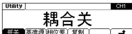
**双通道耦合：**设定基准通道和耦合频率/相位差后，另一通道的频率/相位将随基准通道的改变而改变，并且始终保持所设定的耦合频率/相位差。
