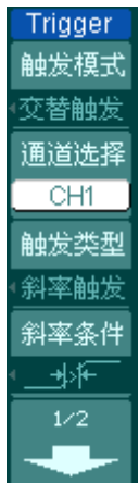
图 2-55 表 2-31 交替触发菜单（触发类型为斜率触发，第一页）
