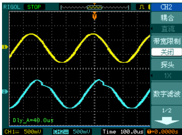
图 3—1 波形畸变示意图
