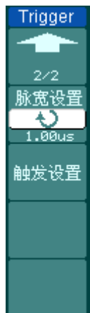
图 2-54 表 2-30 交替触发菜单（触发类型为脉宽触发，第二页）
