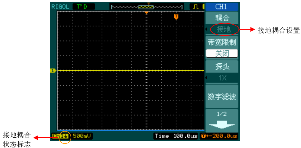
图 2—5 接地耦合设置
