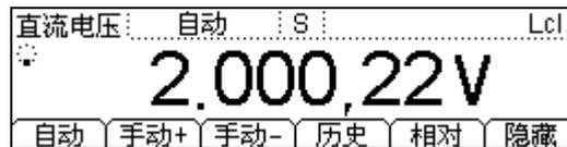
图 2-4 直流电压测量界面
