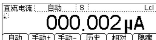
图 2-11 直流电流测量界面
