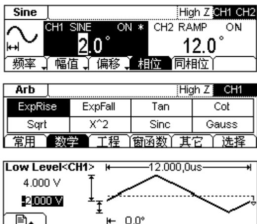
**双通道输出：**可分别设置两个通道的波形和参数及输出开关。操作菜单“同相位”可使能双通道输出时相位同步。
