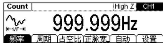
内置频率计测量范围 100 mHz ~ 200 MHz。
