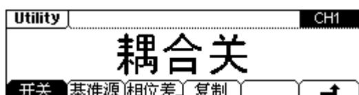
**双通道耦合：**设定基准通道和耦合频率/相位差后，另一通道的频率/相位将随基准通道的改变而改变，并且始终保持所设定的耦合频率/相位差。
